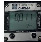
Werden beide Tasten gleichzeitig gedrückt, wird der Konfigurationsmodus aufgerufen, um Maßeinheit und Kalibrierfaktor zu ändern.
